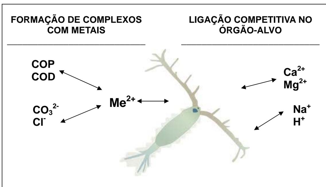
**Figura 1.** Esquema do modelo do ligante biótico (BLM). As setas indicam a formação de complexos do metal ( $Me^{2+}$ ) com o carbono orgânico particulado (COP) e dissolvido (COD), e outros compostos presentes na água, bem como a competição do metal pelo sítio ativo de organismos aquáticos (adaptado de [www.hydroqual.com](http://www.hydroqual.com)).
