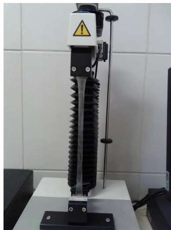
Figura 22. Imagem do filme sendo submetido ao teste de RT e AR
