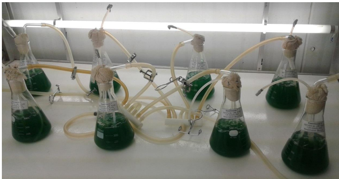
Figura AP1- Ensaio em fotobiorreatores erlenmeyers com a microalga Spirulina sp, LEB 18 na presença dos absorventes carbonato de potássio e dietanolamina
