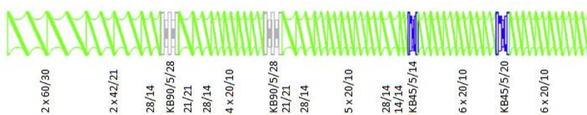
Figura 2 – Representação esquemática de configuração de rosca utilizada no desenvolvimento de extrusados.
