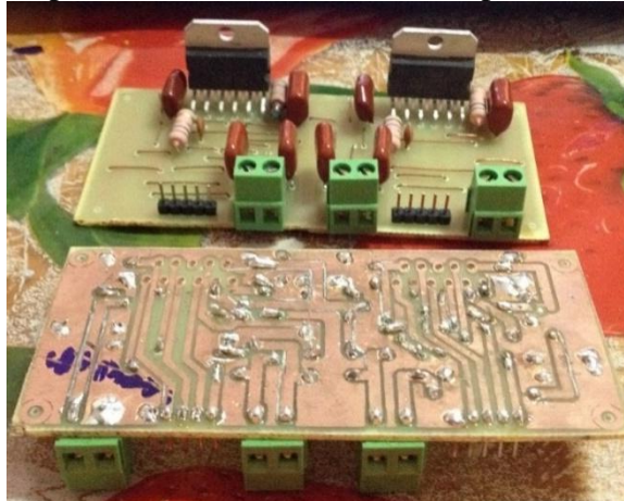
Figura 5.2.51. Circuito impresso do driver dual montado para o controle do motor de passo.
