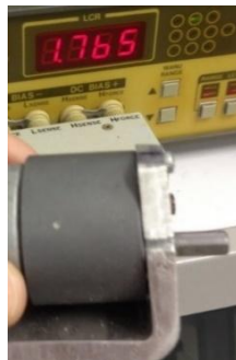
Figura 5.2.10. Medição da indutância do motor com o LCR.
