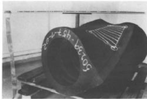
Figura 2.1.2. Programação automatizada (testes na face) numa peça onde a superfície deve ser refeita com soldagem.
