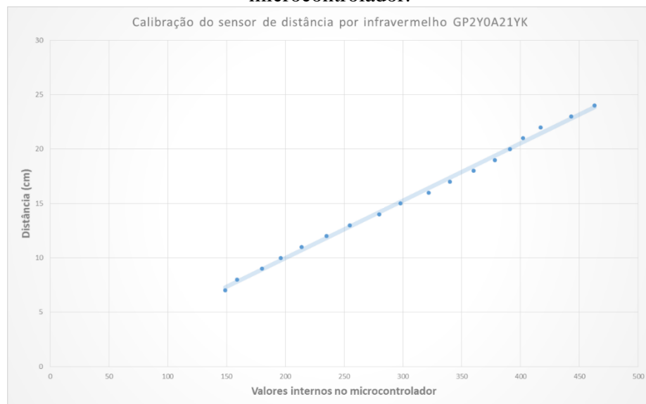
Figura 5.2.46. Gráfica característica do sensor GP2Y0A21YK da SHARP programado no microcontrolador.
