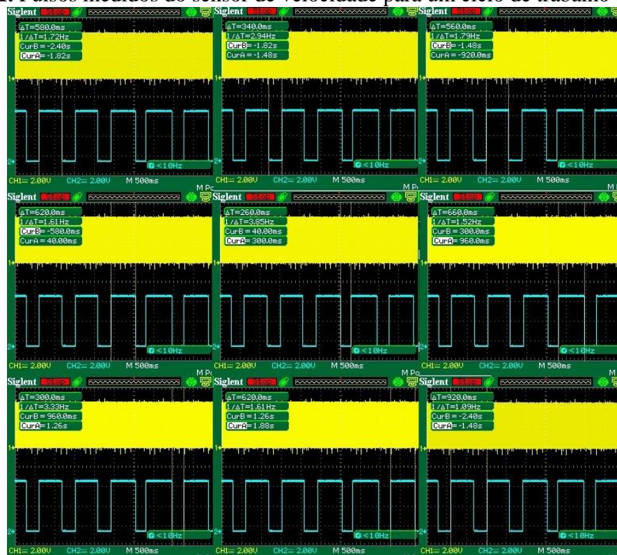
Figura 6.5.1. Pulsos medidos do sensor de velocidade para um ciclo de trabalho do 17,6%
