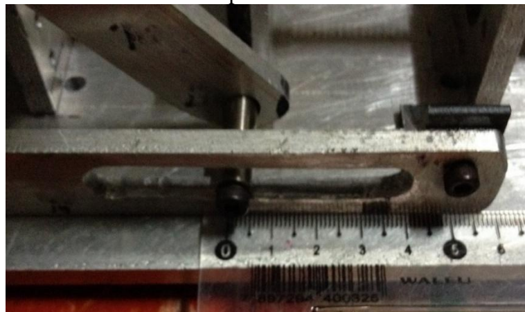
Figura 6.7.1. Deslocamento linear do sistema angular após 7600 passos do motor, o valor medido foi de aproximadamente 38 mm
