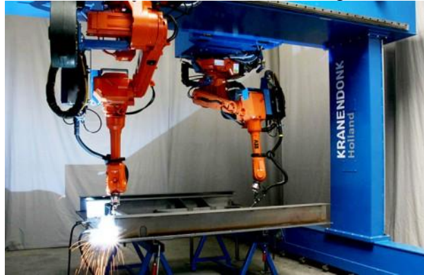
Figura 1.1.1. Sistema robotizado de soldagem de navios.
