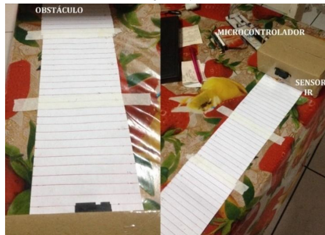
Figura 5.2.45. Calibração e sintonização do filtro passa baixa digital para o sensor GP2Y0A21YK da SHARP programado no microcontrolador, as medições foram feitas cada 10 mm.
