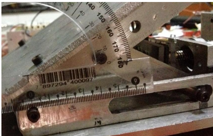
Figura 6.7.2. Ângulo inicial do sistema angular antes os 7600 passos, o valor medido foi de 21^\circ
