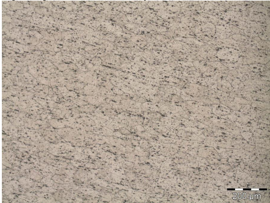
Figura 38 – Imagem da liga 6063 T9 encruada 55%, ampliada 100x.
