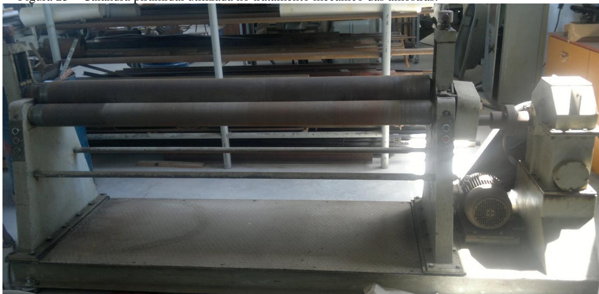
Figura 25 – Calandra piramidal utilizada no tratamento mecânico das amostras.
