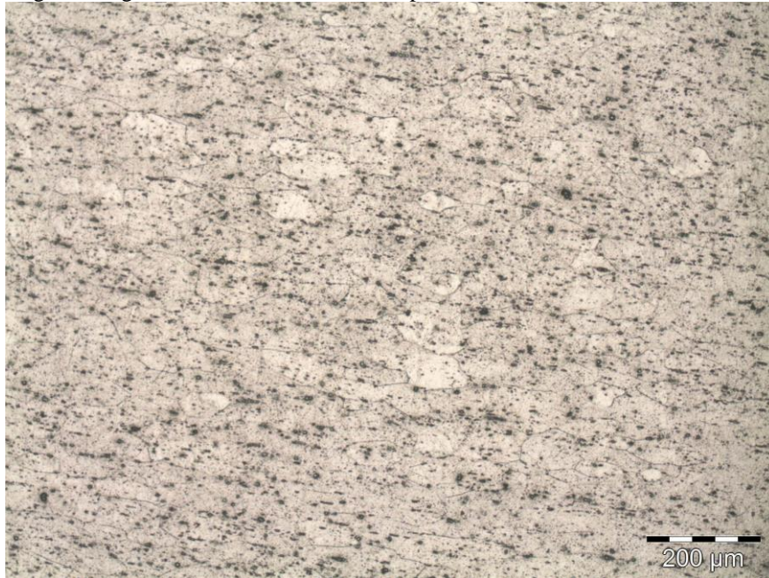
Figura 39 – Imagem da liga 6063 T9 encruada 70%, ampliada 100x.
