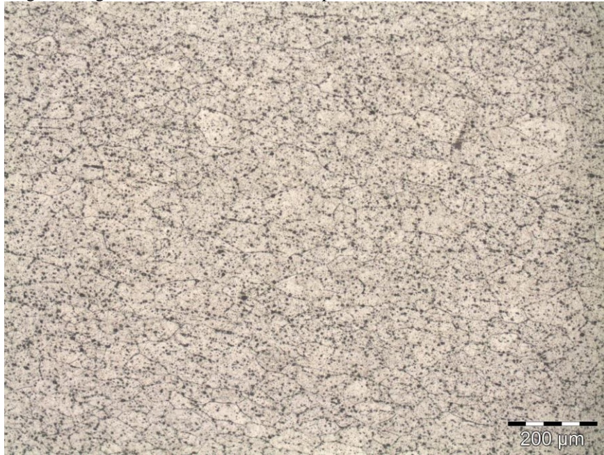
Figura 37 – Imagem da liga 6063 T9 encruada 40%, ampliada 100x.
