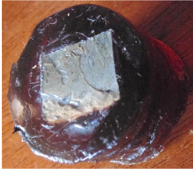
Figura 26 – Corpo de prova para MO (superfície ainda não trabalhada).
