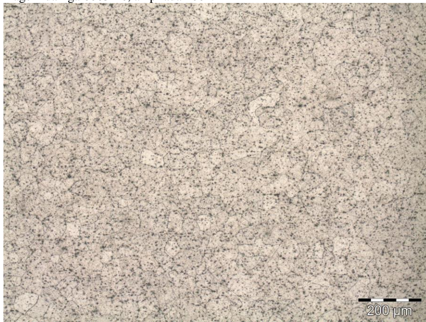
Figura 34 – Imagem da liga 6063 T6, ampliada 100x.
