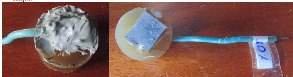
Figura 30 – Corpo de prova para ensaio potenciodinâmico: (a) detalhe do metal embutido; (b) detalhe da vedação.
