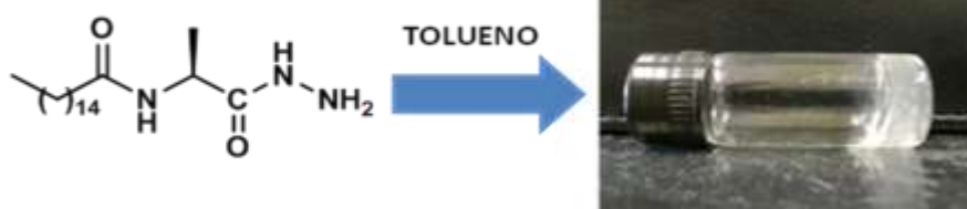
Figura 4 - N -acilamino ácido graxo derivado da alanina e seu organogel em tolueno.
