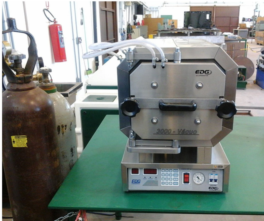
Figura 16: Forno para tratamento térmico com atmosfera controlada
