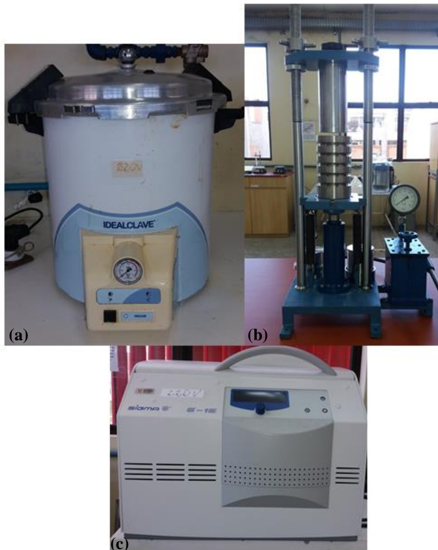
Figura 8 - (a) Cocção das vísceras em autoclave (b) prensa hidráulica e (c) centrífuga
