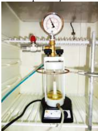
Figura 2 - Módulo de UF utilizado na purificação e concentração da enzima peroxidase.
