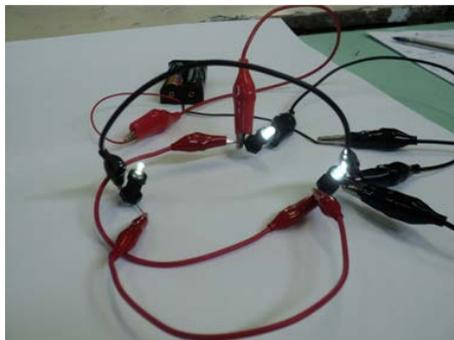
**Figura 50 - Lâmpadas led conectadas em um circuito em paralelo.**
