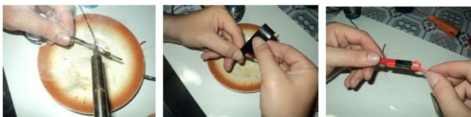
**Figura 42 - Alternativas para tornar os cabos do multímetro mais resistentes ou realizar o conserto dos mesmos.**
