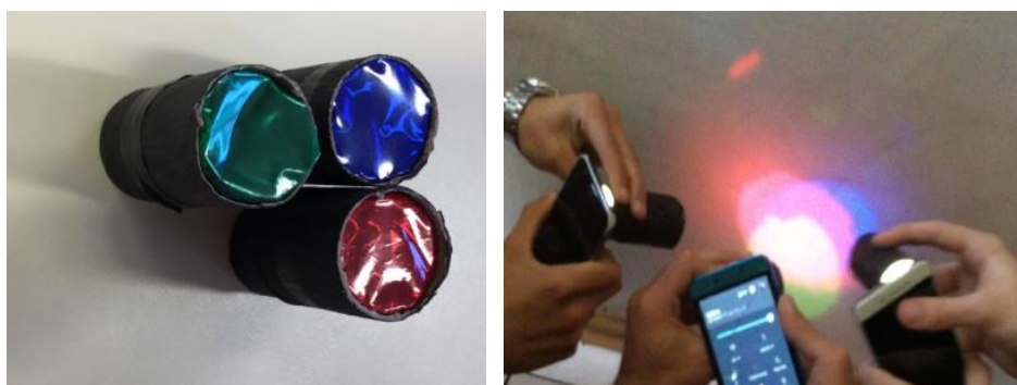
Figura 3.4: Lanternas com filtros nas cores verde, azul e vermelha
