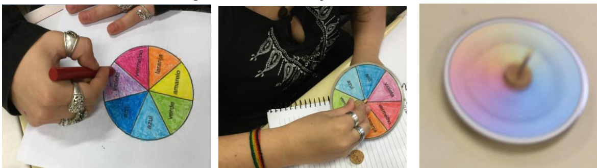
Figura 3.9: Construção do disco de Newton.
