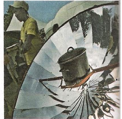
Exemplo de forno solar feito com espelho parabólico.
