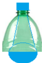
Figura 21 – Bico do foguete com balão contendo areia para estabilizar o dispositivo:
