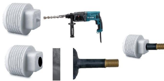
Figura 14 – montagem do bico de ar na base de lançamento:
