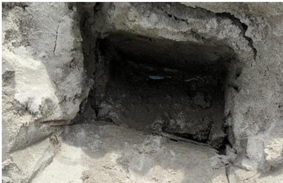
**Figura 68** Afloramento de água em 7cm de profundidade, na zona de interduna.
