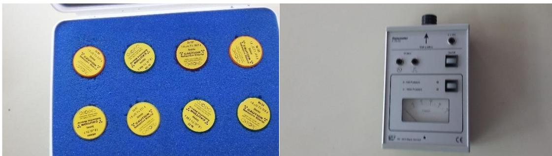
Figura 25: Fontes radioativas com atividades inferiores a 1  $\mu\text{Ci}$  e Medidor Geiger Müller.
