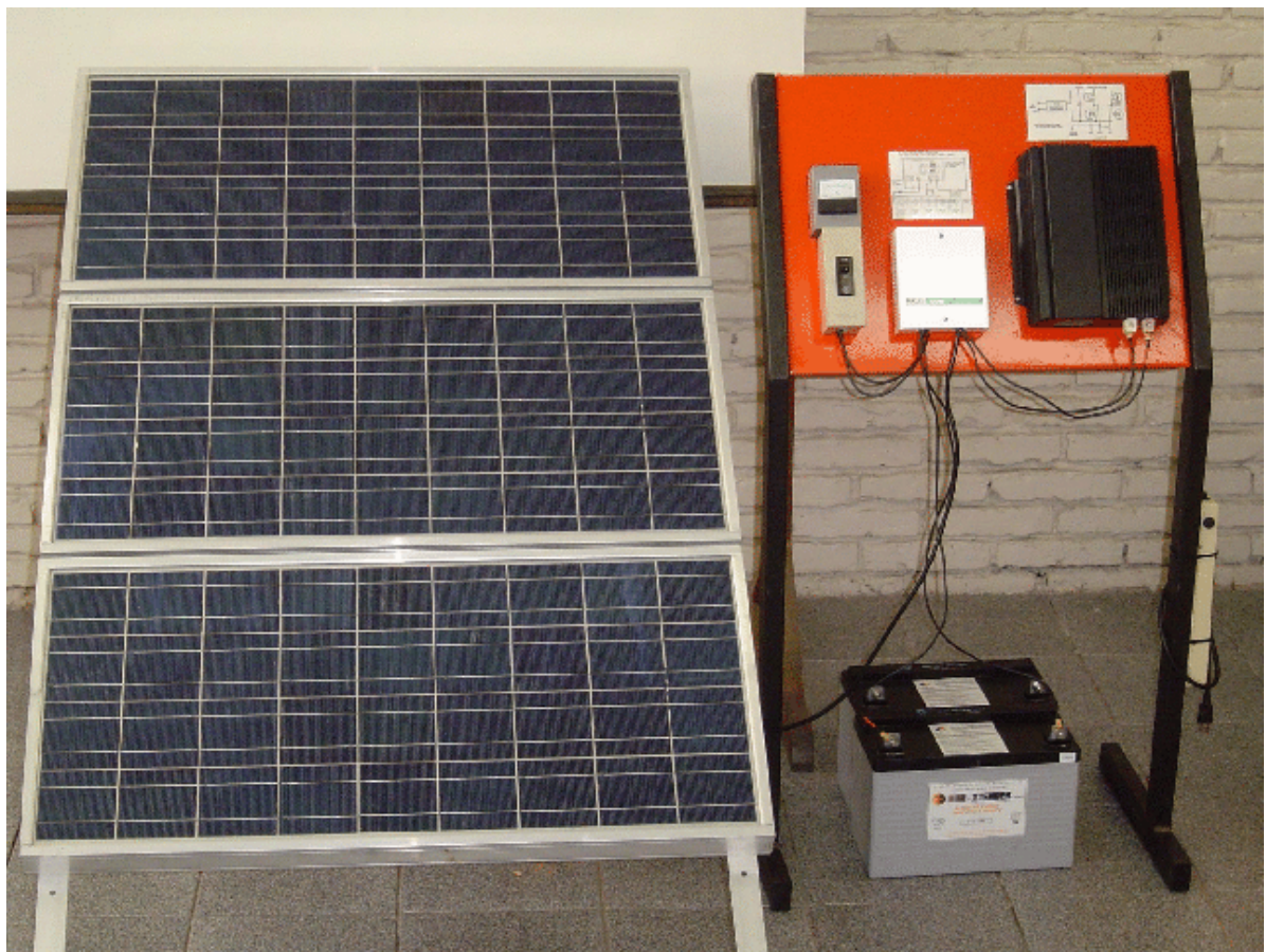
Figura 07 - Placa fotovoltaica Solarex - 39W disponível no CTI, ainda sem aplicação.
