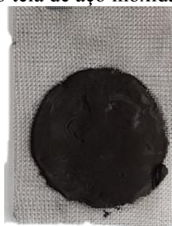
Figura 16: Eletrodo catódico elaborado com carvão ativado, resíduo de pilha e PVDF-HFP sob tela de aço inoxidável
