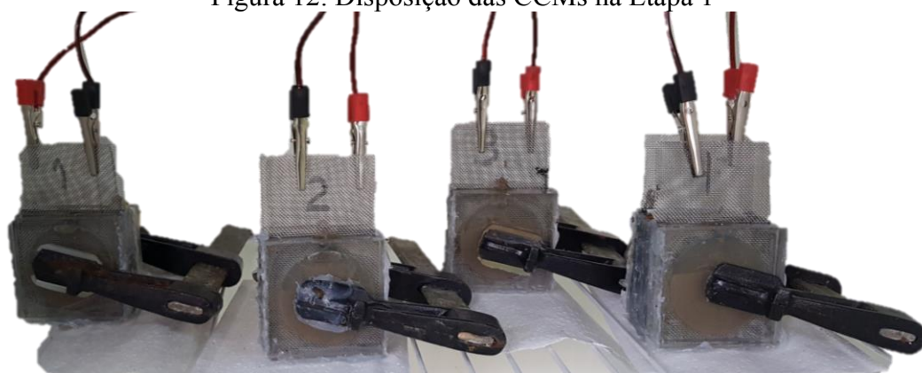
Figura 12: Disposição das CCMs na Etapa 1
