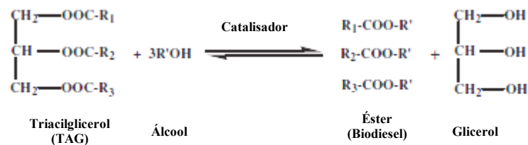
Figura 1 - Reação de obtenção do glicerol como coproduto da produção de biodiesel.
