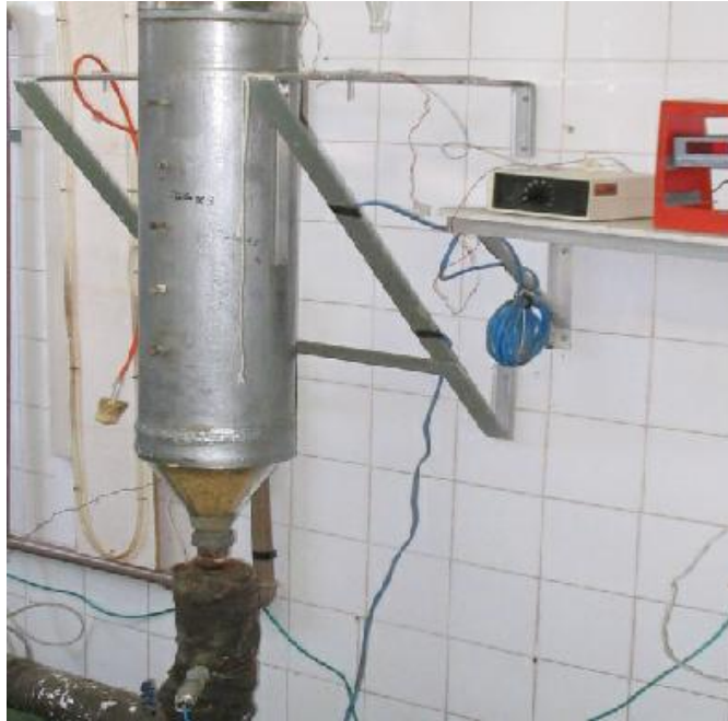
Figura A7: Secador de leite jorro, geometria cone-cilíndrica.
