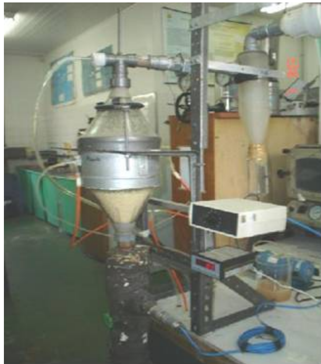
Figura A8: Secador de leite jorro, geometria cônica.
