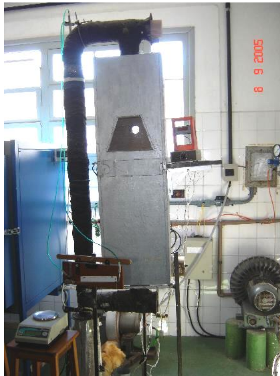
Figura A6: Secador descontínuo de bandejas com escoamento perpendicular do ar.
