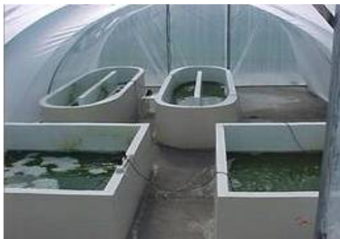
Figura 2: Fotobiorreatores abertos onde é realizado o cultivo de Spirulina platensis localizados no Laboratório de Engenharia Bioquímica da FURG.
