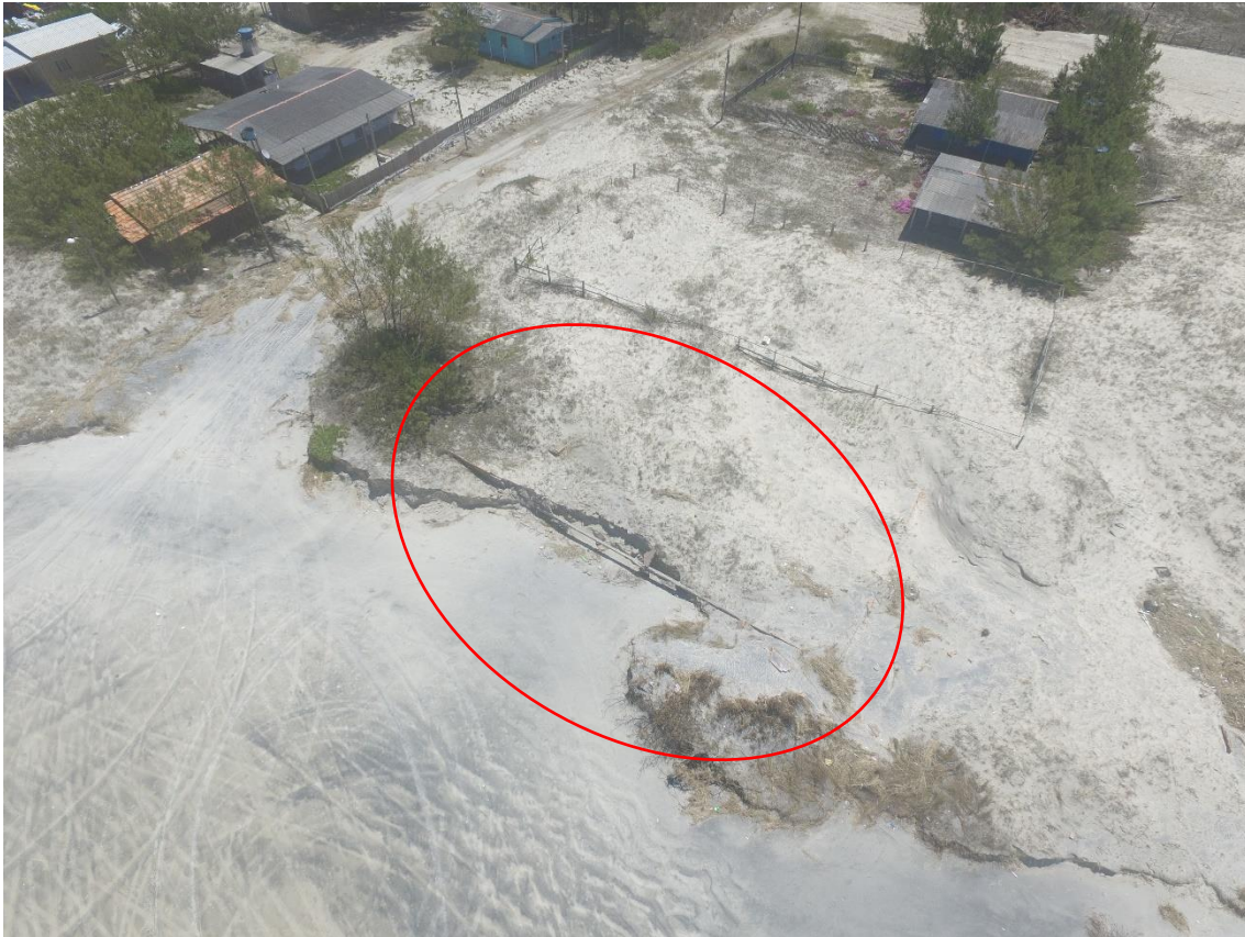
Figura 41. Alicerce de ocupação que estava soterrada, aflorando no pós praia após passagem de evento de alta energia. Fotografia obtida em 5 de novembro de 2016 a partir de um drone.
