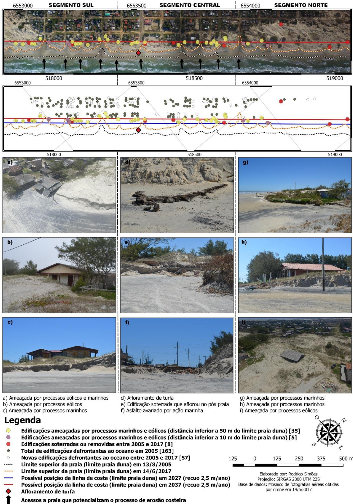
Figura 46. Produto cartográfico síntese da situação das edificações a beira mar em relação aos processos de erosão costeira e movimentação eólica.
