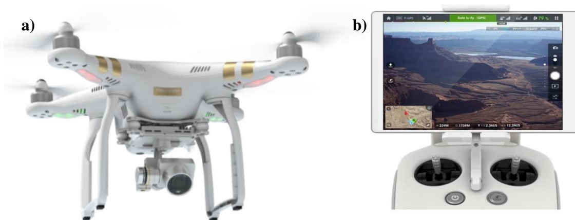
Figura 11. (a) Drone Phantom 3 profissional. (b) Controle do drone Phantom 3 Professional e tablet acoplado, com destaque para as informações contidas na telemetria do equipamento (fonte: www.dji.com ).
