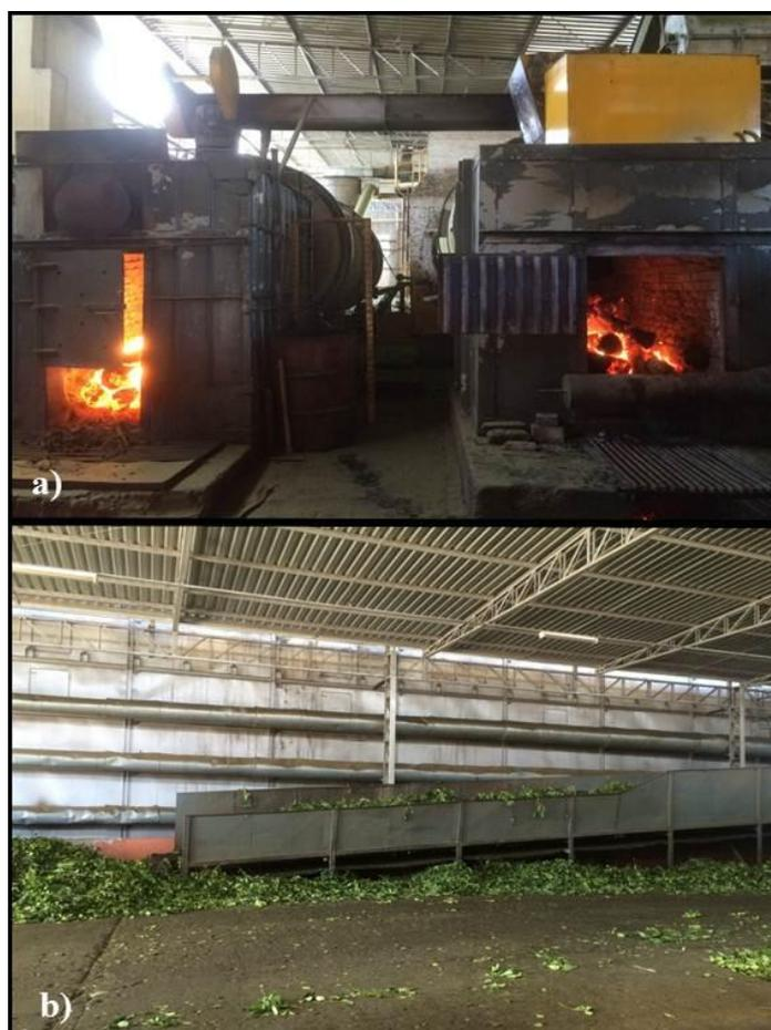
**Figura 4.** Equipamentos de secagem. a) secador rotativo; b) secador de esteira. Fotos como cortesia da ervateira Barão Comércio e Indústria de Erva-Mate LTDA. Barão de Cotegipe – RS.
