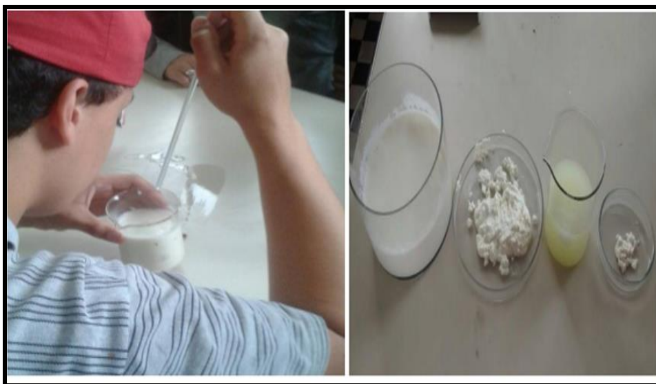
Figura 16 - Atividade experimental para a separação das proteínas do leite
