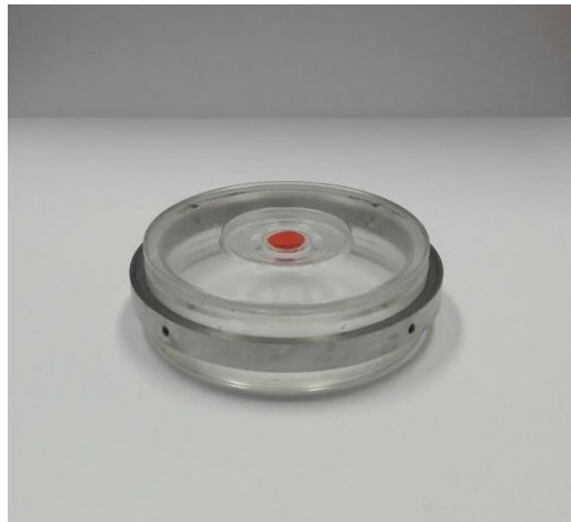
Figura 3.11 - Porta amostra com preenchimento parcial de massa de modelar.
