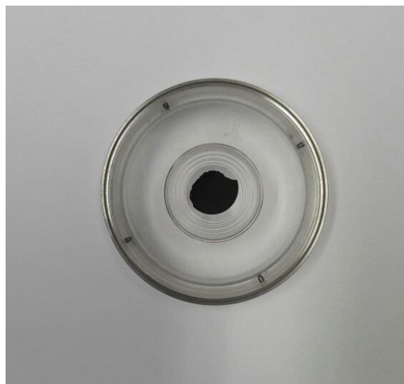
Figura 3.12 - Porta amostra (com a amostra inserida) preparado para coleta de dados.
