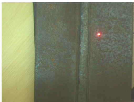
Figura 19: Imagem da chapa metálica com superfície fosca utilizado durante a avaliação experimental.
