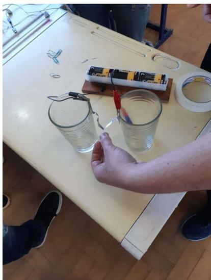
Figura 11: Imagem o experimento montado sobre Força Magnética entre fios.
