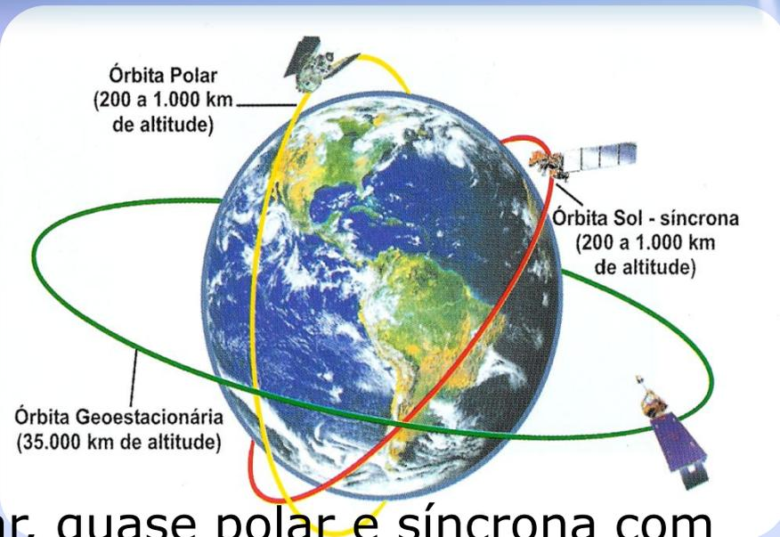
Landsat (700Km) – órbita circular, quase polar e síncrona com o Sol. O satélite se desloca em torno da Terra com a mesma velocidade de deslocamento da Terra em relação ao Sol, o que garante as mesmas condições de iluminação para a superfície terrestre e a passagem aproximadamente no mesmo horário no local sobre os diferentes pontos da Terra.
