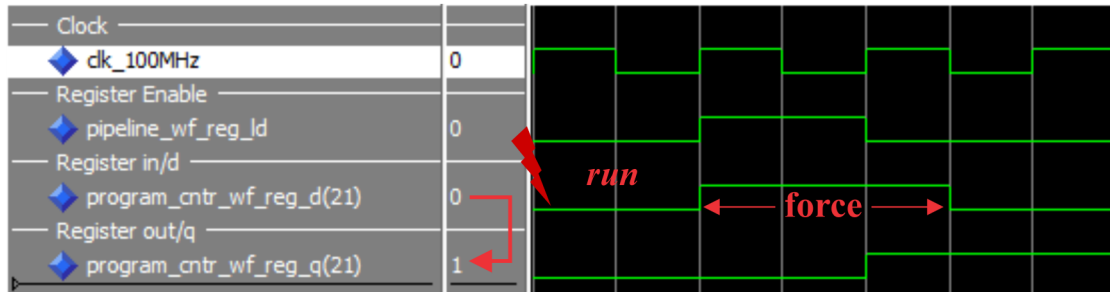
Figura 27 – Exemplo de simulação de um SEU em um registrador do pipeline
