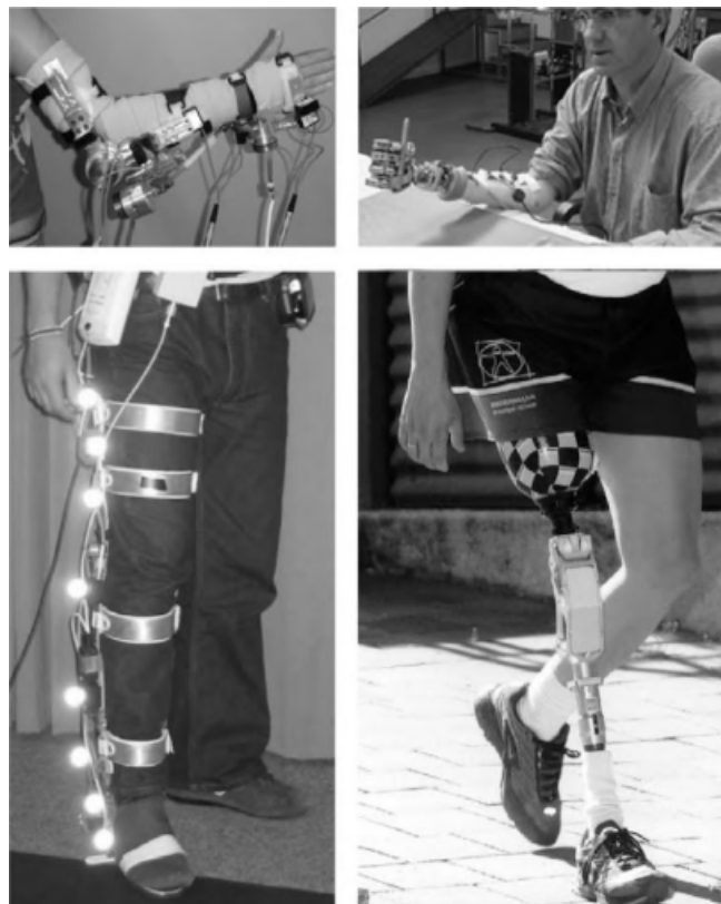
Figura 10: Exemplos de exoesqueletos em membros superiores e inferiores.
