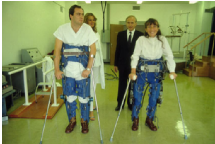
Figura 9: Robô pneumático desenvolvido por Rabischong e Bel (1976).
