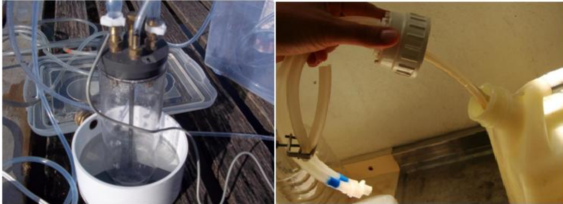
Fig. 7 – À esquerda, imagem do difusor empregado no método RAD-AQUA para determinação de ^{222}\text{Rn} , através do qual a amostra é aspergida na câmara liberando o gás radônio que é quantificado. À direita, imagem da garrafa empregada no método RAD- Big Bottle na qual é coletada a amostra e o gás radônio é liberado na porção superior, posteriormente sendo quantificado.
