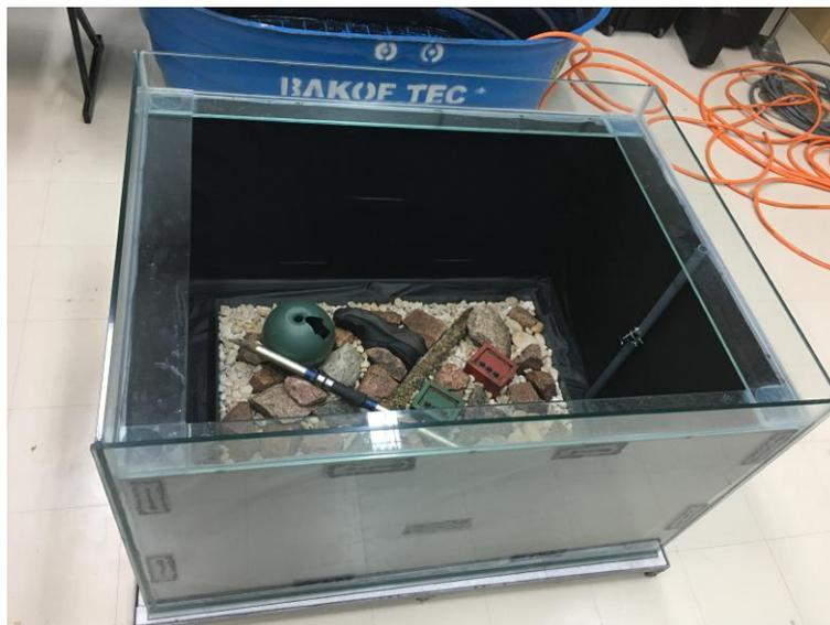
Figura 4 – Estrutura principal do experimento proposto composta por um tanque de vidro com dimensões de 1 x 0,80 x 1,30 metros (Largura x Altura x Comprimento), duas lâmpadas LED colocadas em um *softbox*, uma de cada lado a 30 cm do tanque e uma bandeja de vidro que pode ser utilizada para montar a cena a ser fotografada.
