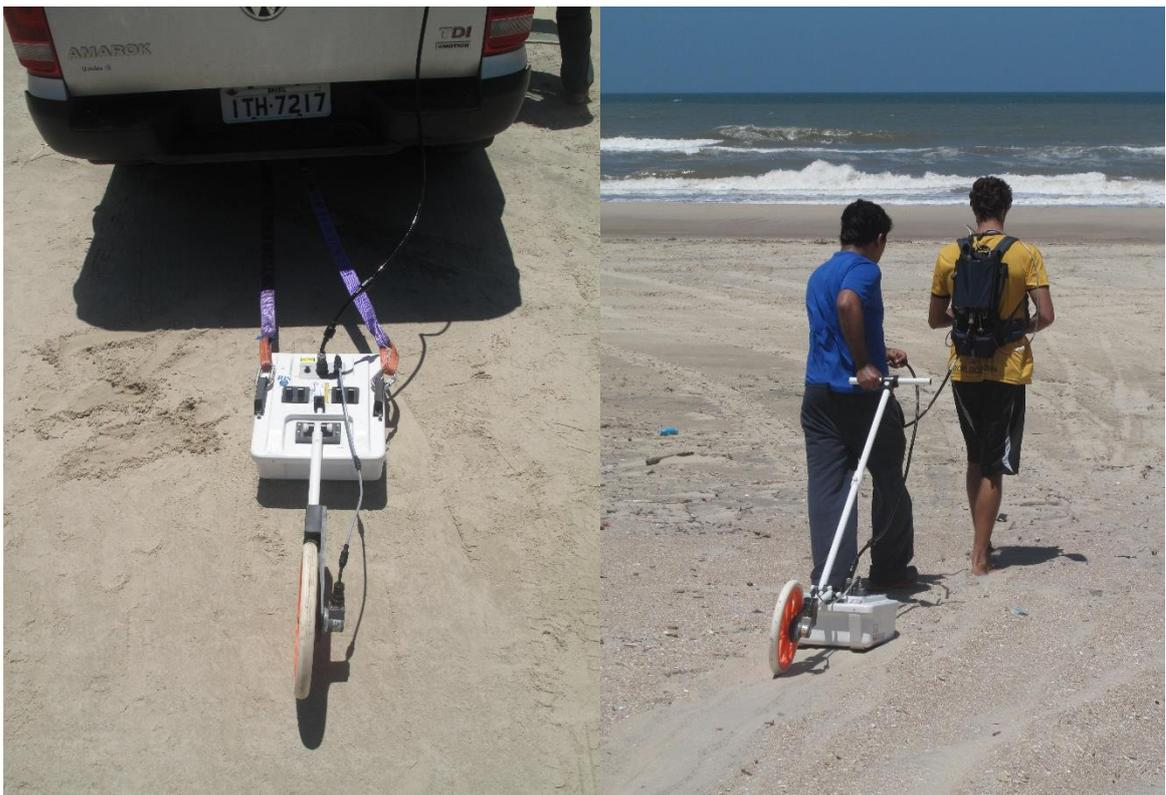
Fig.13 - Esquerda: GPR acoplado atrás de um veículo 4x4 para amostragem longitudinal com a antena de 200MHz. Direita: GPR com antena de 400MHz na região dos perfis, tracionado manualmente.
