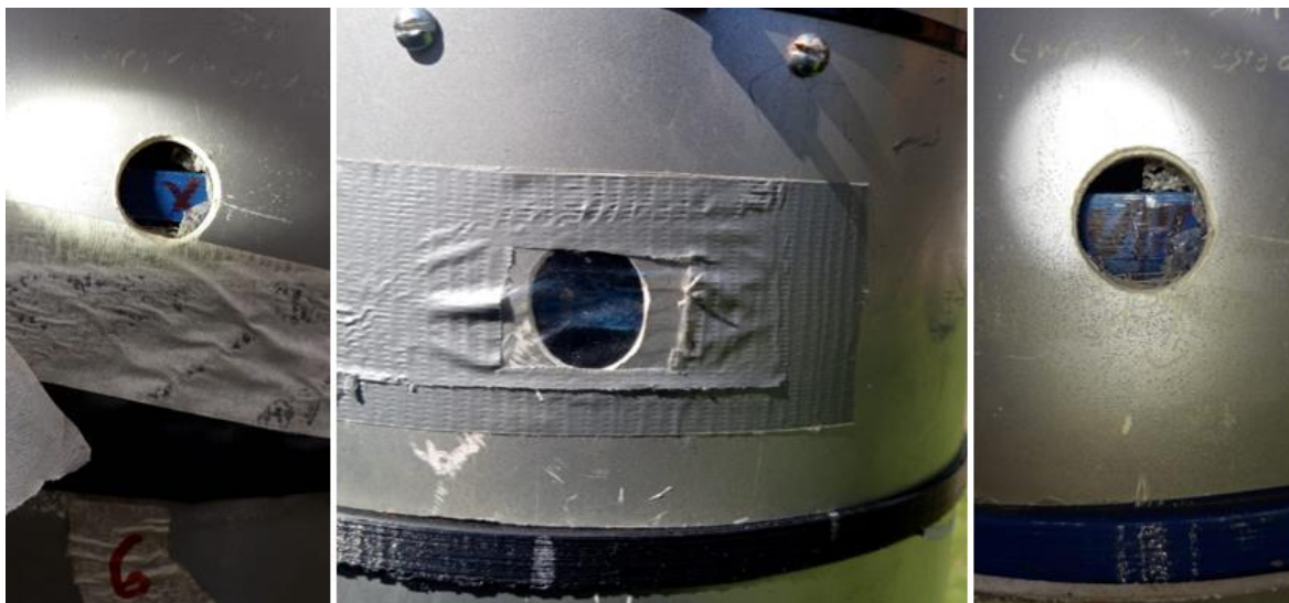
Figura 35. Mostra do orifício de visualização para verificação e controle do mês de coleta giro manual do disco de distribuição.
