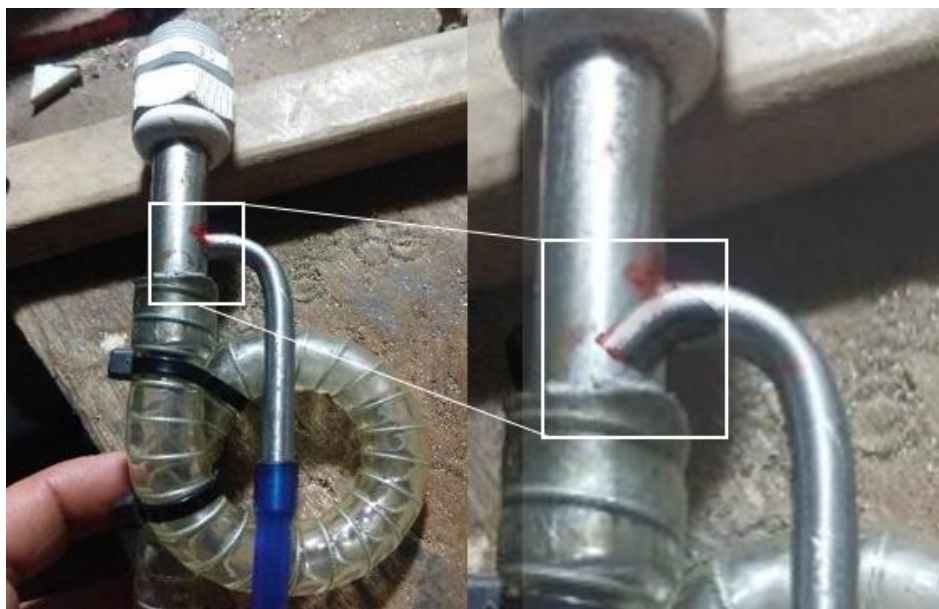
Figura 19. Disposição do suspiro no tubo de conexão.
