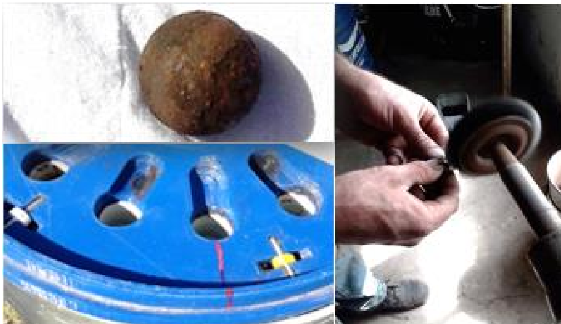
Figura 36. Oxidação da esfera e limpeza efetuada por colaboradores.
