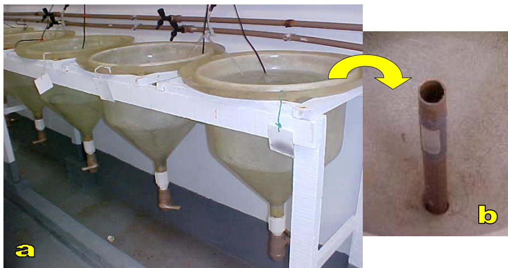
Figura 1. (a) Tanques cilindro-cônicos utilizados no experimento; (b) cano PVC (3cm de diâmetro e 46cm de altura) perfurado e recoberto com uma tela de náilon com cobertura de malha de 300µm.
