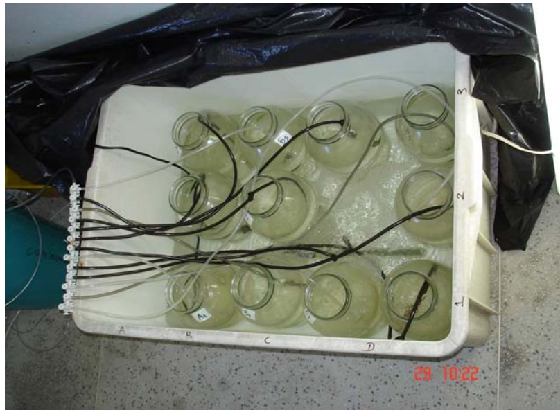
Fig. 2) Sistema de banho-maria utilizado no experimento.
